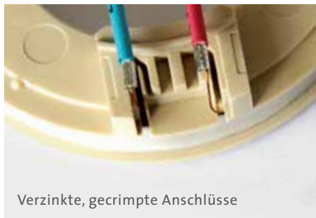
Gecrimpter Drahtanschluss mit Spliceband
